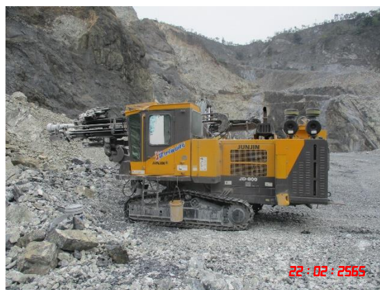
รูปที่ 2-3 รถเจาะระเบิดที่มีเครื่องดูดฝุ่นติดตั้งที่บริเวณหัวเจาะ
